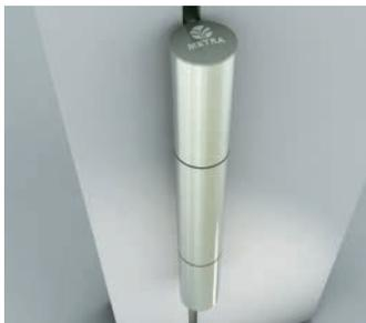
Le cerniere filiformi sono disponibili nella versione a due ali (peso max/anta 100 kg utilizzando due cerniere) e nella versione a tre ali (peso max/anta 150 kg sempre con due cerniere). Regolazione laterale ( $\pm 3$  mm) ed in altezza ( $\pm 4$  mm) senza sollevare l'anta dal telaio.
